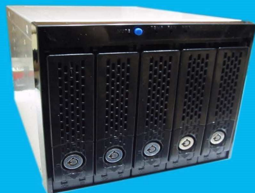
UT_5035I (SATA 介面) 外觀尺寸：220 x 146 x 126 mm (占系統3個5.25吋)
